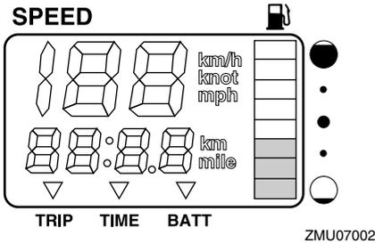
La lectura del nivel de combustible puede ser incorrecta debido a la posición del sensor en el tanque de combustible y por el asiento del barco en el agua. La navegación con el barco apopado o girando continuamente puede dar falsas lecturas.
