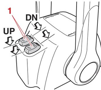
1. Interruptor de elevación y trimado del motor
