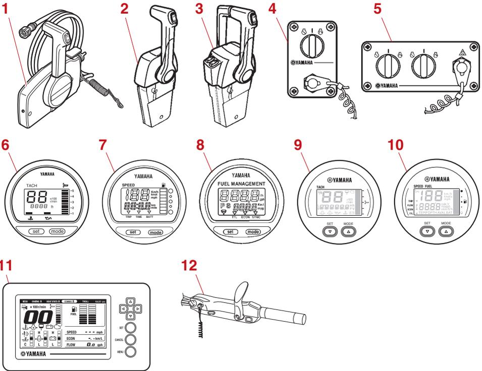
1. Caja de control remoto (tipo de montaje lateral)\*
