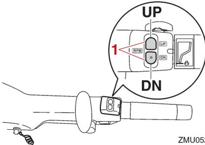
1. Interruptor de RPM para baja velocidad variable
