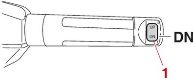
1. Interruptor de elevación y trimado del motor
