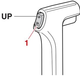
1. Interruptor de elevación y trimado del motor
