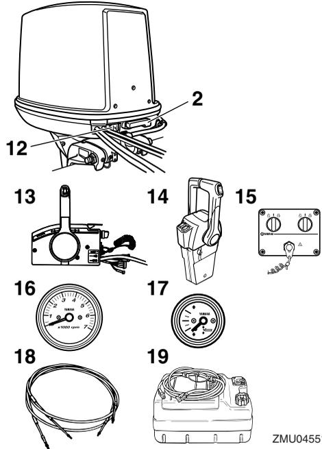
14. Caja de control remoto (tipo de montaje en bitácora)\*
