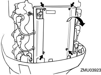
2. Desconecte el cable amarillo (circuito de emergencia) de la unidad CDI para regresar a puerto. **PRECAUCIÓN: Siga este procedimiento sólo en caso de emergencia y durante el tiempo suficiente para regresar a puerto con el fin de realizar la reparación oportuna.**
