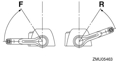
2. Una vez que el motor funcione a velocidad de ralentí con una marcha engranada, mueva la palanca del control remoto firmemente a la posición de punto muerto.
