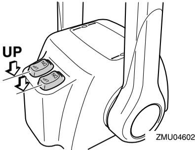
3. Para volver a colocar el motor fueraborda en la posición de funcionamiento normal, pulse el interruptor de elevación y trimado del motor y baje lentamente el motor fueraborda.
