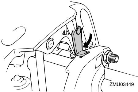
4. Una vez que el motor fueraborda esté apoyado en el soporte del motor elevado, pulse el interruptor de elevación y trimado del motor “DN” (abajo) para replegar las varillas de trimado. **PRECAUCIÓN:** Asegúrese de retraer completamente las varillas de trimado durante el amarre. Esto protege los empujadores contra la adherencia marina y la corrosión que podrían dañar el mecanismo de elevación y trimado de motor (PTT). [SCM00254]
