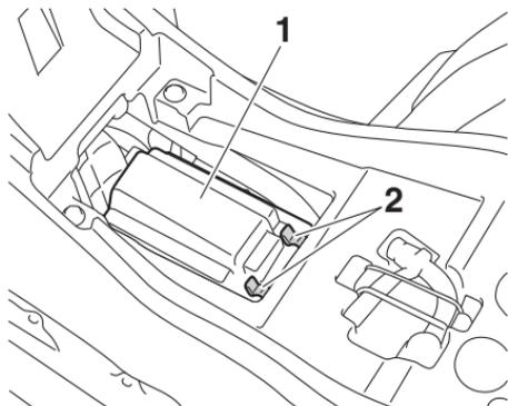
1. Cubierta de la caja del filtro de aire
