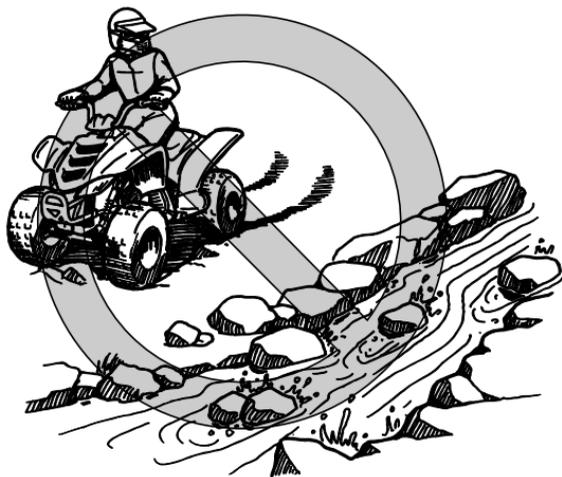
Compruebe los frenos cuando salga del agua. Si es necesario, accíonelos varias veces para que la fricción seque el forro. No siga conduciendo el ATV sin comprobar que éste ha recuperado su capacidad de frenado. **¡ADVERTENCIA! Si los frenos están mojados, la capacidad de detener el vehículo puede verse reducida, con el consiguiente riesgo de perder el control.** [SWB02622]
