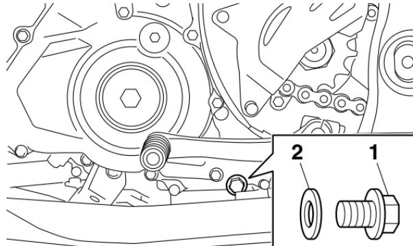
1. Perno de drenaje del depósito de aceite de motor
