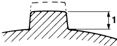
1. Profundidad del dibujo de la banda de rodadura del neumático
