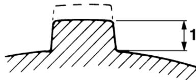
1. Profundidad del dibujo de la banda de rodadura del neumático
