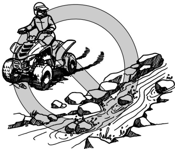
Compruebe los frenos cuando salga del agua. Si es necesario, frene varias veces para que el rozamiento seque los forros. No siga conduciendo el ATV sin comprobar que éste ha recuperado su capacidad de frenado. **¡ADVERTENCIA! Si los frenos están mojados, la capacidad de detener el vehículo puede verse reducida, con el consiguiente riesgo de perder el control.** [SWB02622]
