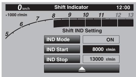
6. Seleccione “IND Stop” y luego gire el interruptor giratorio para ajustar las rpm a las que la luz indicadora de cambio de marcha se apagará. El margen de funcionamiento de “IND Stop” es de 5500–13000 r/min.
