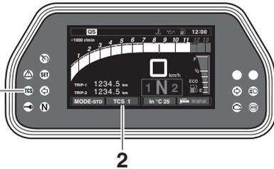
1. Luz indicadora del sistema de control de tracción “TCS”
