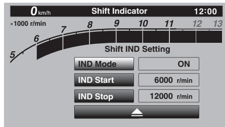
3. Seleccione “ON” para que la luz indicadora brille de manera constante, “OFF” para apagar el indicador, o “Flash” para que el indicador de cambio de marcha parpadee al alcanzar el límite establecido de revoluciones.
