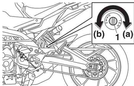
1. Tornillo de ajuste del hidráulico de extensión
