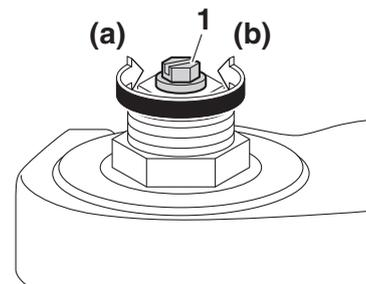
1. Tornillo de ajuste del hidráulico de compresión
