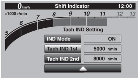
5. Para definir el límite inferior de r/min, gire y presione brevemente el interruptor giratorio. Todas las rpm por encima de este valor hasta el valor de ajuste de “Tach IND 2nd” (o la zona roja) se muestran en verde.
