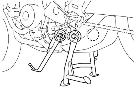
Antes de cada utilización debe comprobar el funcionamiento de los caballetes central y lateral y engrasar los pivotes y las superficies de contacto metal-metal según sea necesario.
