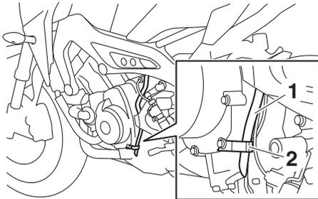
1. Tubo de desbordamiento del depósito de gasolina
