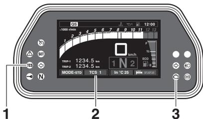
1. Luz indicadora del sistema de control de tracción “TCS”
