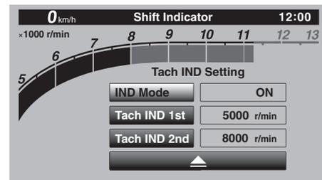
3. Seleccione ON para activar el modo de visor en color del tacómetro (o seleccione OFF para desactivar esta función).
