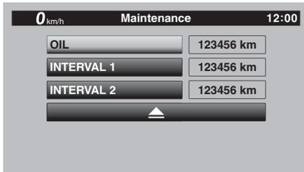
3. Efectúe una pulsación larga sobre el interruptor giratorio para poner a cero el elemento.
