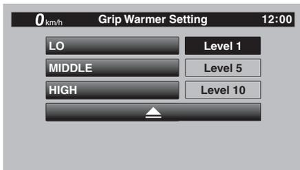
4. Para ajustar el nivel de temperatura de otra configuración de los calentadores de los puños, repita desde el paso 2 o seleccione el símbolo del triángulo para salir de este módulo.
