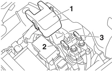
1. Tapa del relé del motor de arranque
