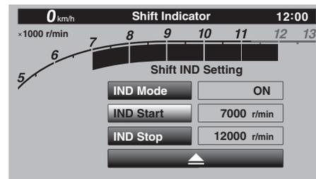
5. Gire el interruptor giratorio para ajustar las rpm a las que la luz indicadora de cambio de marcha se encenderá. El margen de funcionamiento de “IND Start” es de 500–12800 r/min.
