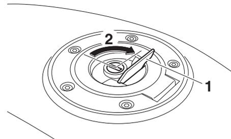
1. Cubierta de la cerradura del tapón del depósito de gasolina
