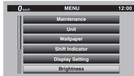
2. Para seleccionar el nivel de brillo que desee, gire el interruptor giratorio y luego presiónelo brevemente para fijar el ajuste.
