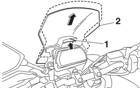
1. Palanca de bloqueo del parabrisas
