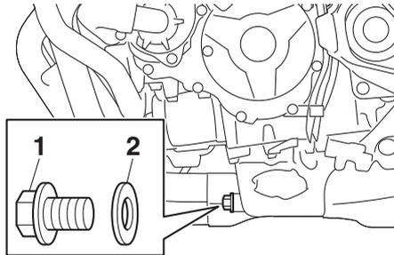
1. Perno de drenaje del aceite del motor
